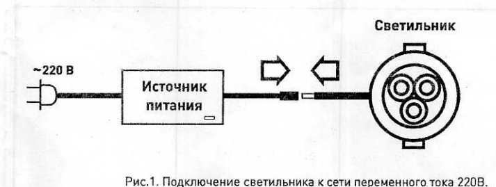
Рис.1. Подключение светильника к сети переменного тока 220В.
