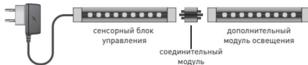
**Внимание! Для правильного функционирования системы, источник питания необходимо подключать в специально обозначенное гнездо на корпусе управляющего модуля.**
